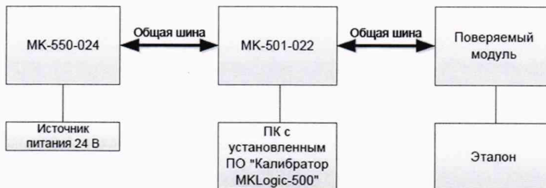
Рисунок 5 – Схема подключения при поверке
