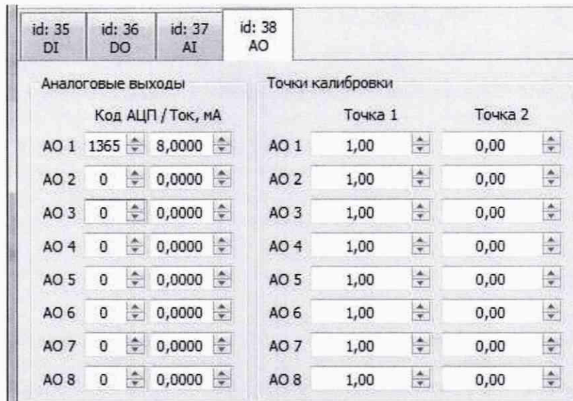
Рисунок 4. Окно калибровки в ПО «Калибратор МКLogic-500» для модулей вывода аналоговых сигналов.
