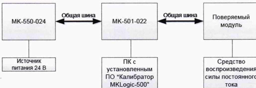
Рисунок 1 – схема подключения при опробовании
